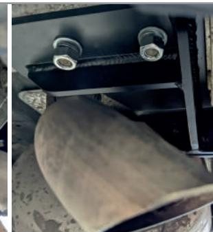
**ШАГ 2.** Зафиксируйте положение правого кронштейна на штатных шпильках возле правой подушки крепления глушителя при помощи гаек M12, шайб 12 и шайб 12 гроверных.
