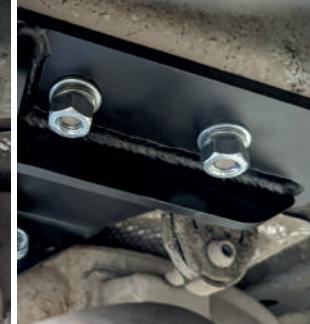
**ШАГ 3.** Закрепите балку ТСУ на правом и левом кронштейнах при помощи болтов M10x1,25x35, шайб 10, шайб 10 гроверных и гаек M10x1,25. **Затяните все соединения, отрегулировав положение ТСУ.**
