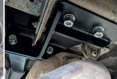
**ШАГ 4.** Установите съёмный шар в сборе и закрепите его пальцем гнутым гальванизированным со шплинтом пружинным игольчатым. Затяните шар ключом на 38 мм. Установите фиксирующий болт M10x20 с шайбой 10 снизу, он используется для исключения технологических люфтов съемного шара и только в ненагруженном состоянии! Перед сцепкой болт демонтировать! Установка завершена!
