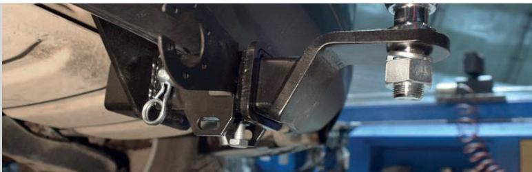
Тип соединения: шаровый; Диаметр сцепного шара: 50 мм.; Масса комплекта ТСУ 11041501: 17,7 кг.
