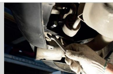
**ШАГ 4.** Затяните все резьбовые соединения. Установите шар в сборе. Зафиксируйте шар пальцем для фаркопа и продените в него шплит. Затяните нижний винт крепления M10x20. Затяните шар с помощью ключа на 38 мм. Установка завершена.
