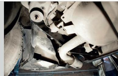
**ШАГ 3.** Установите центральный кронштейн, совместив отверстия в кронштейне центральном с отверстиями в боковых кронштейнах и соедините всё с помощью болтов M10x40x1,25, гаек M10x1,25, шайб M10 и шайб пружинных M10.
